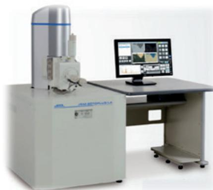
Microscope électronique à balayage
